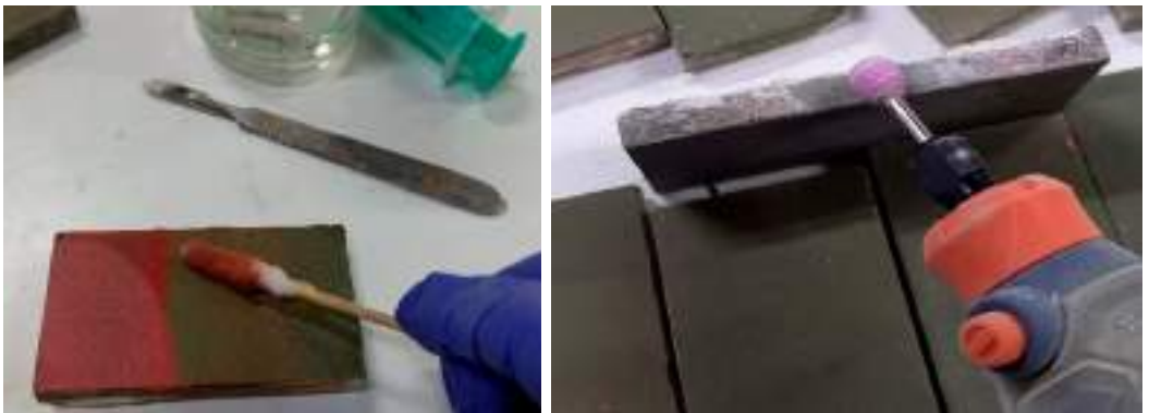
Figuras 16 y 17. Proceso de la limpieza química para llevar a cabo la eliminación de grafitis y proceso de limpieza mecánica en seco para lograr la eliminación de los restos de mortero con el uso de micro tornos.
