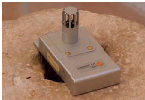
11. Termohigrómetro de registro utilizado para el estudio de monitorización higrotérmica en edificios. Iglesia de Rejas de San Esteban (Soria) (imagen de los autores).
