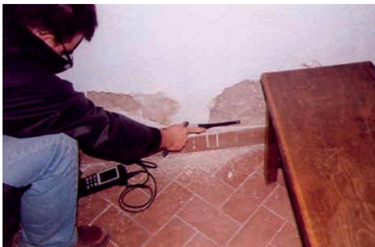
1. Toma de datos instrumentales, mediante termohigrómetro (imagen de los autores).
