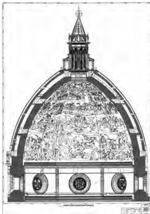
3. Rilievo topografico e fotogrammetrico della cupola (1995), sezione trasversale. (Soprintendenza per i Beni A. e A. di Firenze.)
