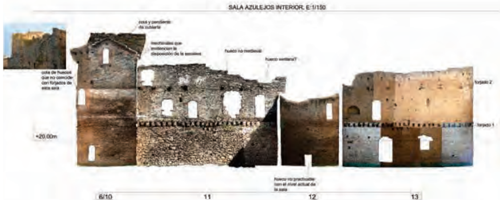
13. Estudio de paramentos de las salas palaciales del castillo de Ponferrada después de su desescombro. Arq. Fernando Cobos.
