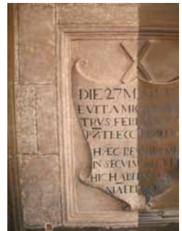
Fig. 19,20 i 21. Proves de neteja mitjançant projecció d'àrid a pressió controlada. Portal lateral esquerre. Fig. 19,20 y 21. Pruebas de limpieza mediante proyección de árido a presión controlada. Portal lateral izquierdo
