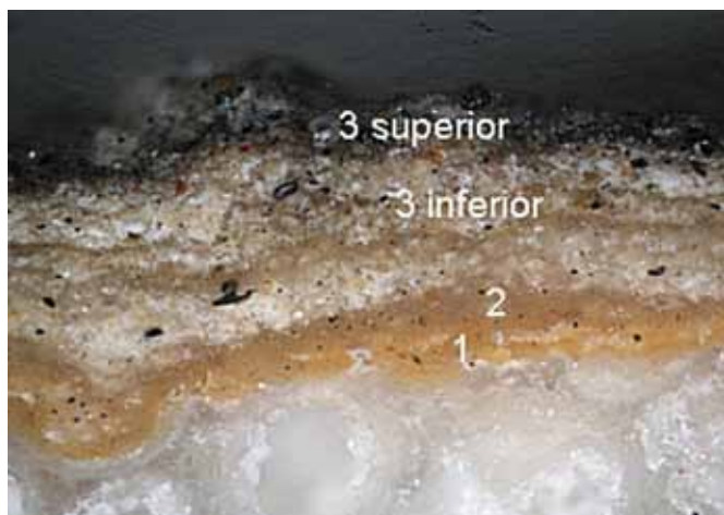
Fig. 12. Estratigrafia (llum reflectida) de la mostra FST-1, del recobriment de la pedra de la façana del convent de Santa Teresa. Palma de Mallorca. Fig. 13. Cromatograma de la mostra FST-1, no mostra components orgànics aglutinants. Fig. 12.- Estratigrafía (luz reflejada) de la muestra FST-1, del recubrimiento de la piedra de la fachada del Convento de Sta. Teresa. Palma de Mallorca. Fig. 13.- Cromatograma de la muestra FST-1, no muestra componentes orgánicos aglutinantes
