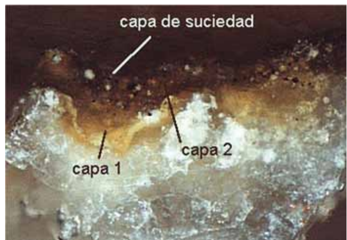
Fig. 5a. Estratigrafia d'una mostra procedent del portal occidental, catedral de Mallorca. Llum reflectida. Hi estan marcades les capes 1 i 2. Quan s'indica capa de brutor es fa referència a la capa 3. Fig. 5b. Estratigrafia d'una mostra procedent del portal del Mirador, catedral de Mallorca. Llum reflectida. Hi estan marcades les capes 1 i 2. Quan s'indica capa de brutor es fa referència a la capa 3. Fig. 5a. Estratigrafia de una muestra procedente de la Portada Occidental, catedral de Mallorca. Luz reflejada. Están marcadas las capas 1 y 2. Cuando se indica capa de suciedad se hace referencia a la capa 3. Fig. 5b. Estratigrafia de una muestra procedente de la Portada del Mirador, catedral de Mallorca. Luz reflejada. Están marcadas las capas 1 y 2. Cuando se indica capa de suciedad se hace referencia a la capa 3
