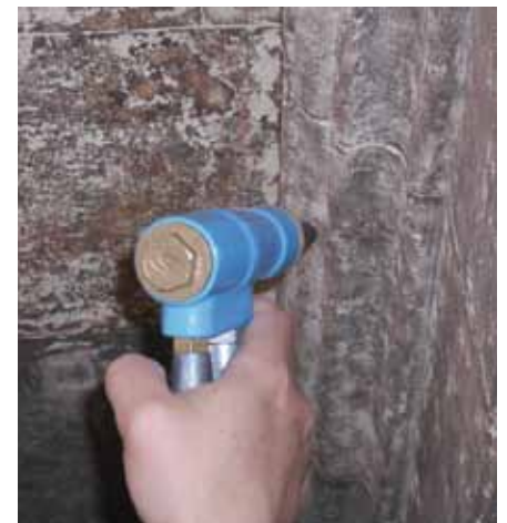
Fig. 16,17 i 18. Proves de neteja amb diferents sistemes. Portal lateral esquerre. Fig. 16,17 y 18. Pruebas de limpieza con diferentes sistemas. Portal lateral izquierdo
