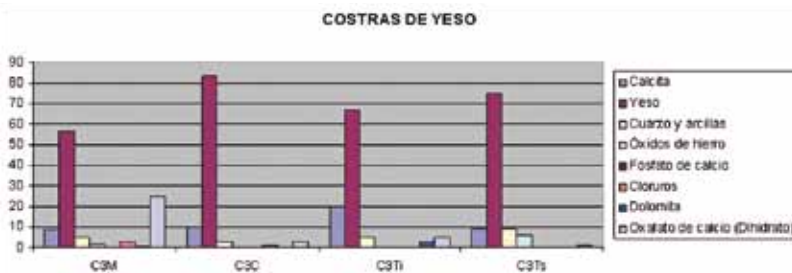
Fig. 14 c. Composicions percentuals de les crostes de guix. Clau: C1, C2, C3 signifiquen capa 1, capa 2 i capa 3. M es refereix a Montision, C a catedral, A a Almudaina i T a Santa Teresa. Fig. 14 c. Composiciones porcentuales de las crostras de yeso. Clave: C1, C2, C3 significan capa 1, capa 2 y capa 3. M se refiere a Montesión, C Catedral, A Almudaina y T Sta. Teresa
