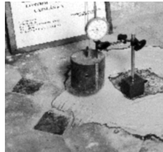
Prueba de carga de un tramo de escalera de construcción tradicional en el palacio de Can Mercader, Cornellà (Baix Llobregat, Barcelona), realizada antes del desmontaje del elemento, programado en el curso de la restauración y adaptación del edificio. Fotos: M. Baldomà, 12.01.1999.
