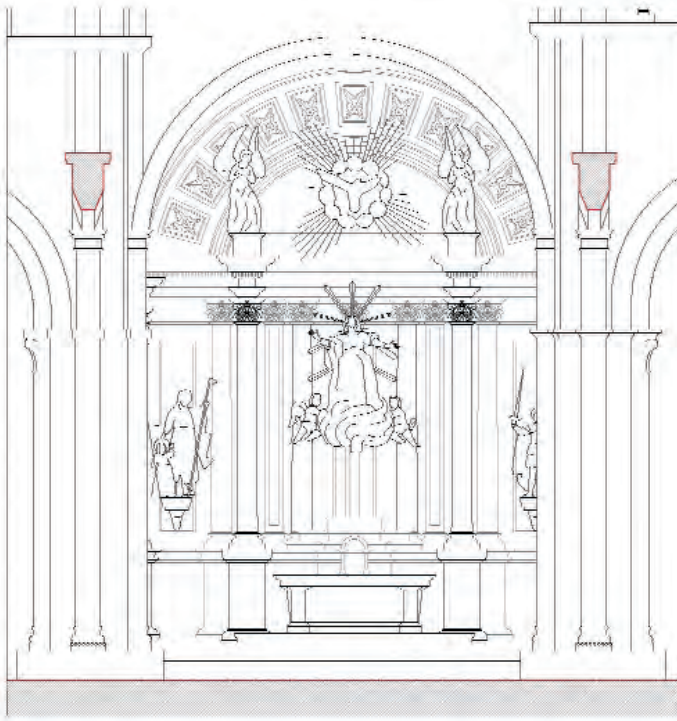
Restitución planimétrica del retablo del altar mayor y colocación del mismo en su posición original. Planimetría desarrollada por el Plan Director
