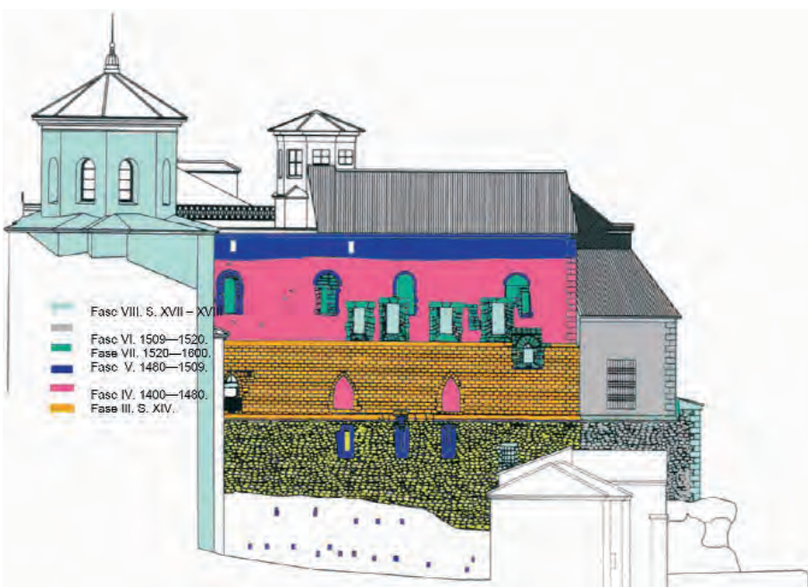
Análisis estratigráfico en colores de los cuerpos de fábrica 1 y 2. Fuente: Proyecto de restauración y rehabilitación de la Catedral de Cuenca
