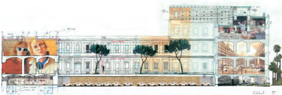
Coupe transversale, sur la cour Est, projet de construction partiel du primo piano. Orientation pour l'utilisation future du bâtiment: à gauche habiter, à droite travailler (université); au centre un grand jardin. Au niveau 0: des ateliers, des restaurants, des boutiques, sous la cour un parking. Dibujo-collage: Nicolas Detry, 2007
