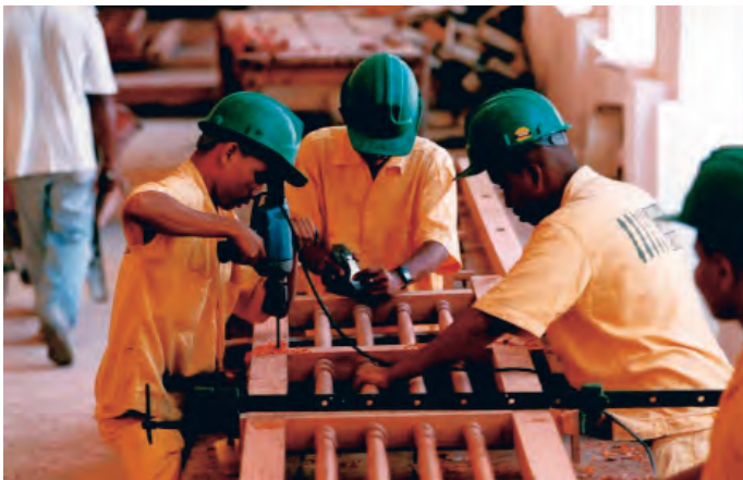
Aprendices de la Escuela Taller, elaborando rejas de madera par el Claustro. Fuente: Proyecto de rehabilitación del Convento de Santo Domingo de Cartagena de Indias
