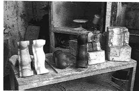
Motllos i peces ceràmiques reproduïdes dels models originals per restaurar la tribuna de migdia. Foto: M. Baldomà. SPAL, 1992.
